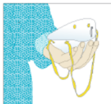
Figura 2. Como colocar e testar o ajuste facial do respirador de partículas
